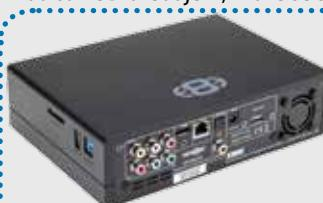
**Procesor:** RTD1186 - 750Mhz - 512MB SLC Flash - 512MB DDR3 SDRAM
